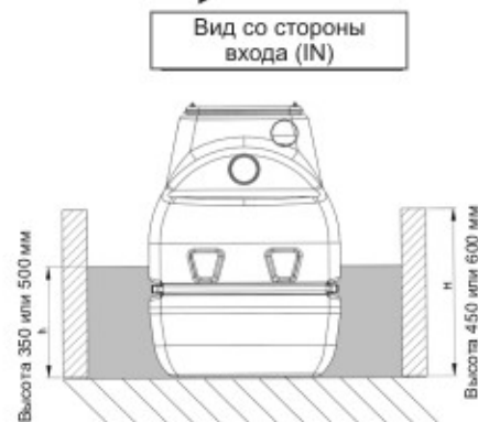
Жироулавливатель SL-SG (предназначен для придомовых локальных очистных сооружений)
