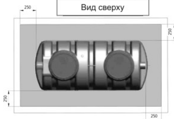
Жироулавливатель SL-SG (предназначен для придомовых локальных очистных сооружений)
